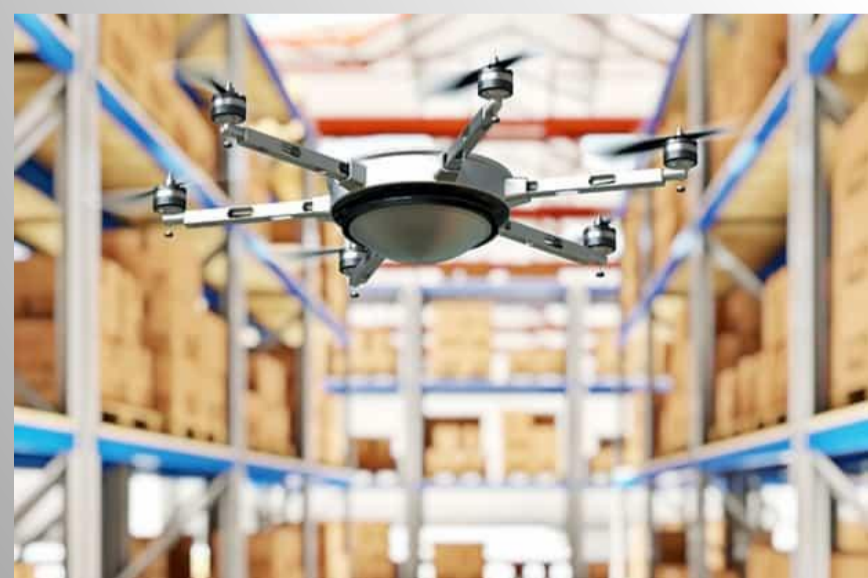
Dron z przekaznikiem RFID zajmujący się skanowaniem towarów w magazynie i przekazywaniem danych do czytnika
